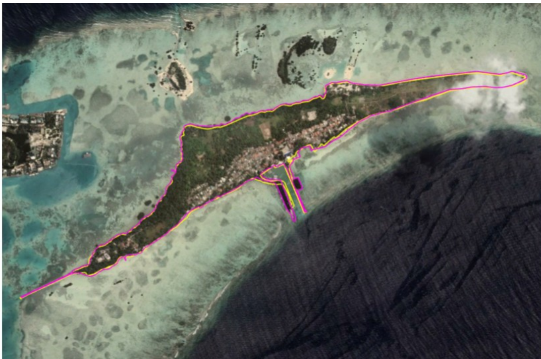
Abbildung 13: Veränderung der Küstenlinie auf Pari von 2009 bis 2021. Die gelbe Linie zeigt die Küstenlinie der Insel Pari im Jahr 2009, die pinke Linie zeigt die Küstenlinie im Jahr 2021. Quelle: Google Earth, Data SIO, NOAA, U.S. Navy, NGA, GEBCO © 2023 Maxar Technologies.
